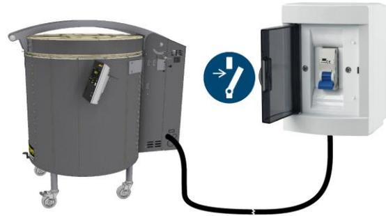
Horno con conexión fija
