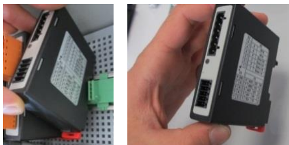
Odstranitev modulov regulatorja – 2. del (podobno kot na sliki)
