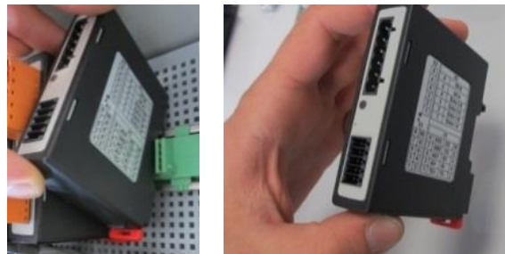
Demontering av reglermoduler, del 2 (liknar dem på bilden)
