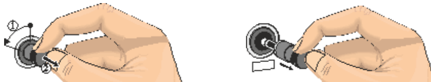
Fig. 54: Løsn sikringsholderen og træk den ud (eksempelbillede)
