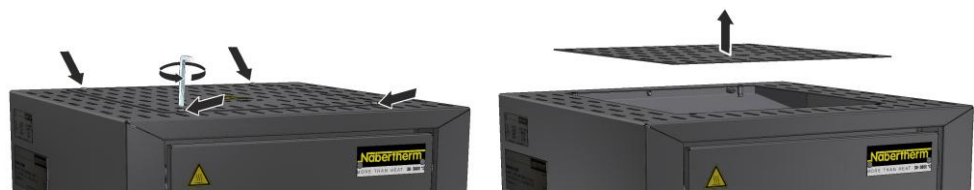
Fig. 36: Afmonter afdækning i siden (eksempelbillede)
