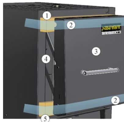
Afb. 11: Transportbeveiliging verwijderen (afbeelding vergelijkbaar)
