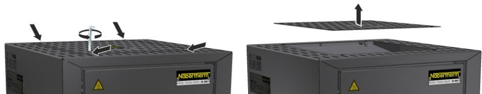
46. ábra: Burkolat leszerelése (az ábrán láthatóhoz hasonlóan)
