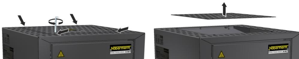
31. ábra: Burkolat leszerelése (az ábrán láthatóhoz hasonlóan)
