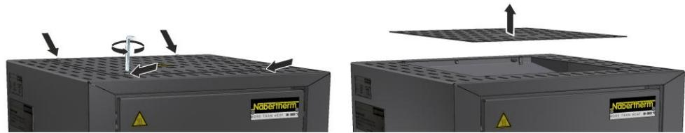
Fig. 46: Desmontaje de la cubierta (figura análoga)
