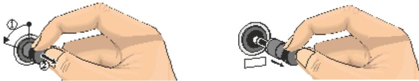
Fig. 54: Cómo soltar y extraer el portafusibles (figura análoga)
