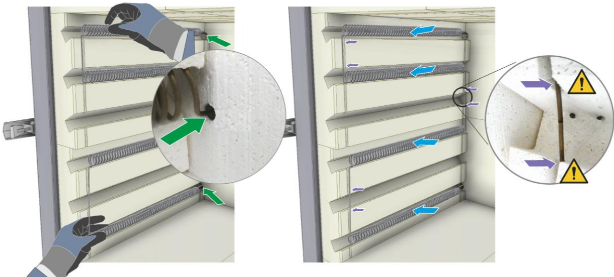
Déposer le fil chauffant dans les rainures de la brique isolante (figure similaire)
