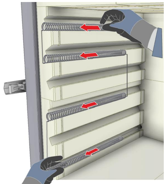
Retirer avec précaution les éléments chauffants hors du four
