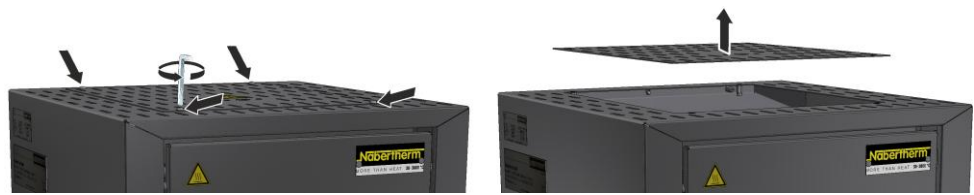
Joonis 36. Katte demonteerimine (sarnane joonis)
