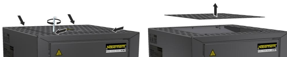
Joonis 41. Katte demonteerimine (sarnane joonis)
