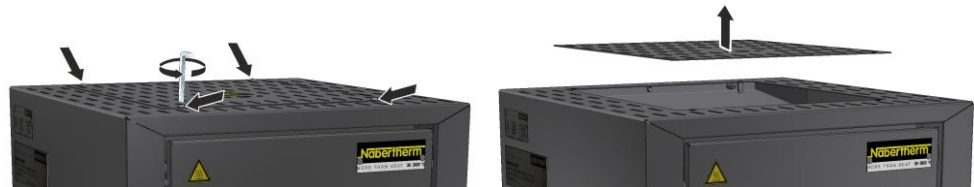
Joonis 51. Katte demonteerimine (sarnane joonis)
