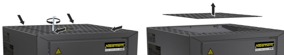
Joonis 17. Katte demonteerimine (sarnane joonis)
