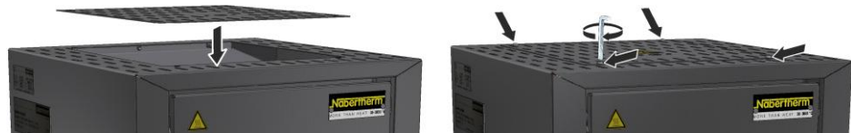
Joonis 38. Katte montaaž (sarnane joonis)
