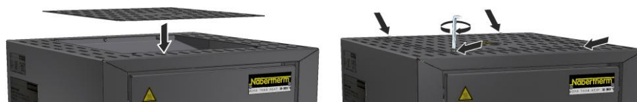
Joonis 19. Katte montaaž (sarnane joonis)
