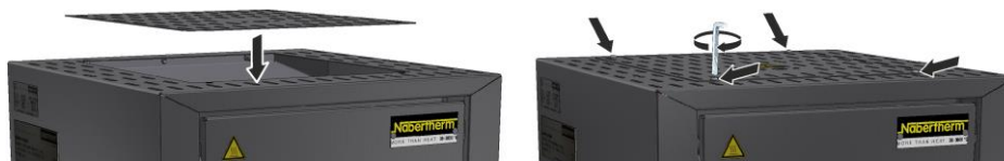
Obr. 47: Montáž krytu (podobne ako na obrázku)
