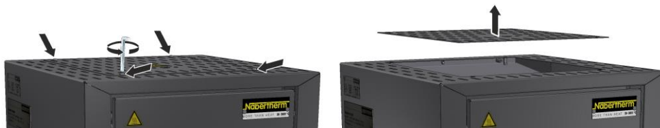
Obr. 41: Demontáž krytu (podobne ako na obrázku)
