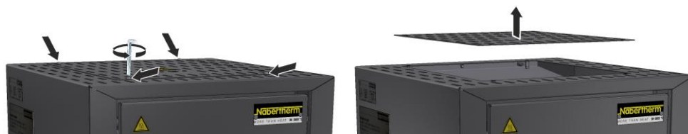
Obr. 51: Demontáž krytu (podobne ako na obrázku)
