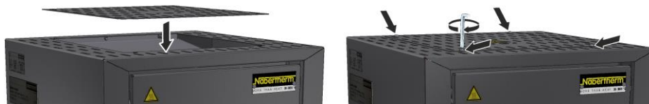
Obr. 19: Montáž krytu (podobne ako na obrázku)
