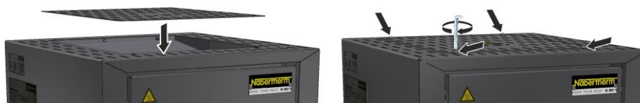
Obr. 38: Montáž krytu (podobne ako na obrázku)
