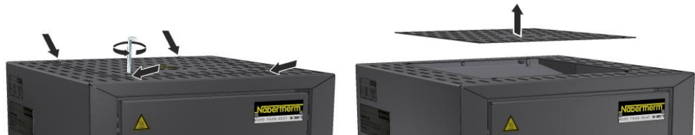
Fig. 36: Desmontaje de la cubierta (figura análoga)
