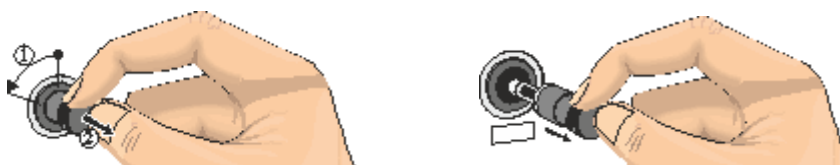
Fig. 57: Cómo soltar y extraer el portafusibles (figura análoga)
