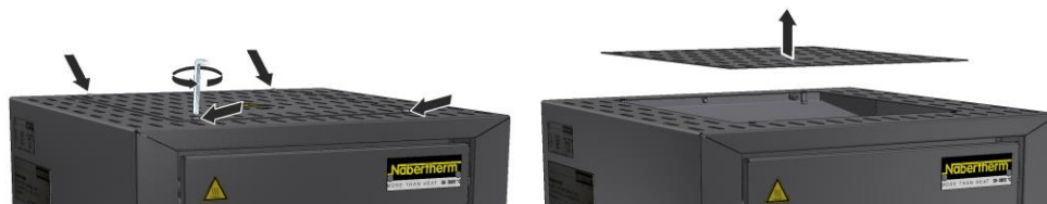
Fig. 17: Desmontaje de la cubierta (figura análoga)
