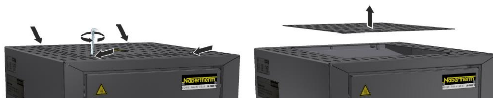
Fig. 51: Desmontaje de la cubierta (figura análoga)
