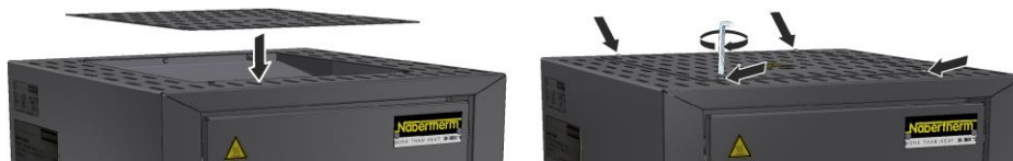
Fig. 38: Montaje de la cubierta (figura análoga)
