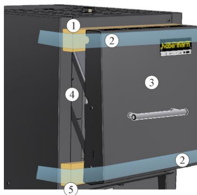
Fig. 13: Cómo retirar la sujeción de transporte (figura análoga)
