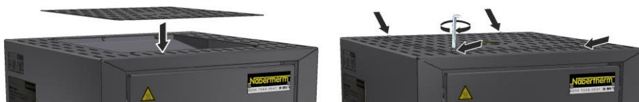
Fig. 19: Montaje de la cubierta (figura análoga)
