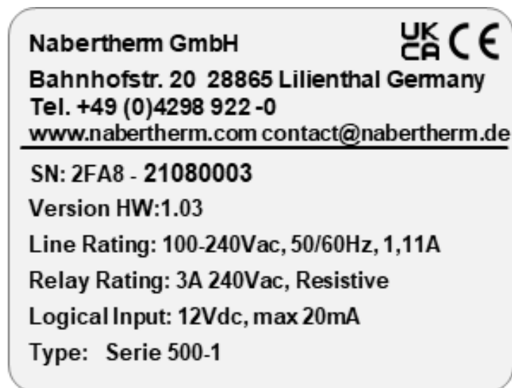
Slika 8: Primer (tipska ploščica upravljalne enote)
