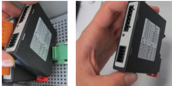
Regülatör modüllerinin sökülmesi – Bölüm 2 (şekil benzer)
